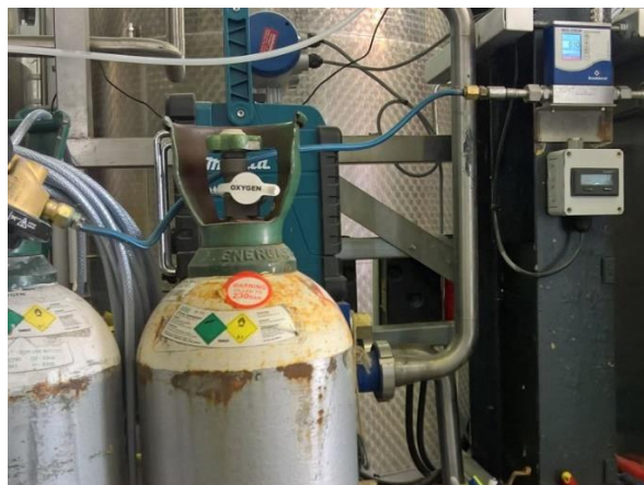
Регуляторы расхода газа MASS-STREAM в процессе аэрации пивного сусла на заводах Heineken (слева) и Ossett Brewery (справа)
